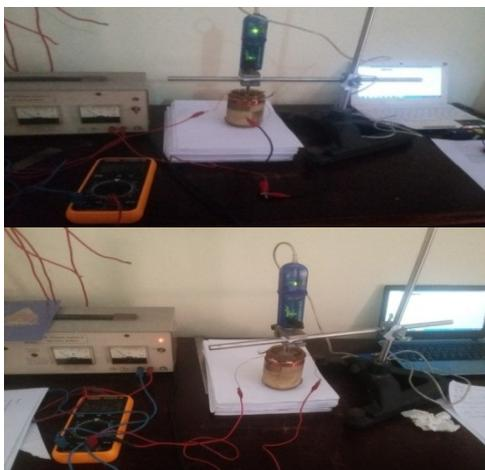
**Gambar 1.** Rangkaian pengukuran induksi magnetik untuk  $B_0$  dan  $B_T$ .
