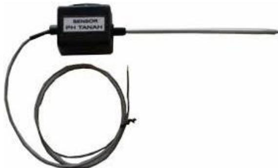
**Gambar 2.** Sensor pH tanah.
