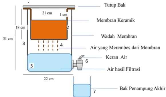
**Gambar 1.** Desain unit membran keramik.
