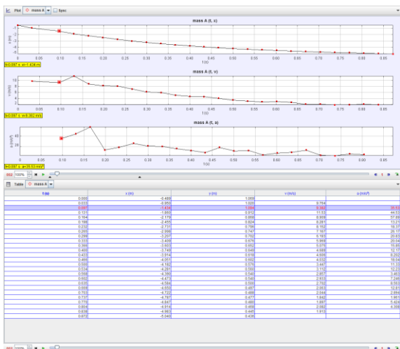
Gambar 6. Grafik dan tabel data jarak, percepatan, dan kecepatan terhadap waktu pada mobil pick up hitam.
