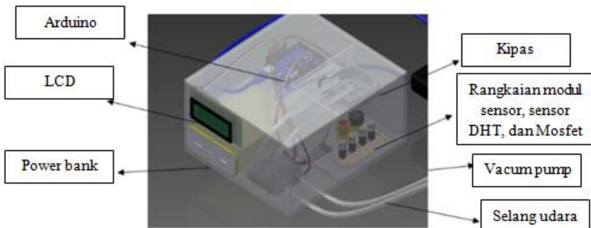
**Gambar 2.** Perangkat keras hidung elektronik.
