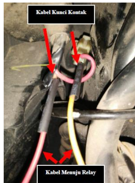
Gambar 7. Kunci kontak yang sudah dihubungkan dengan relay.
