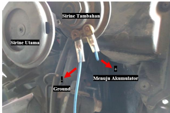
Gambar 8. Sirkuit pemasangan sirine tambahan.
