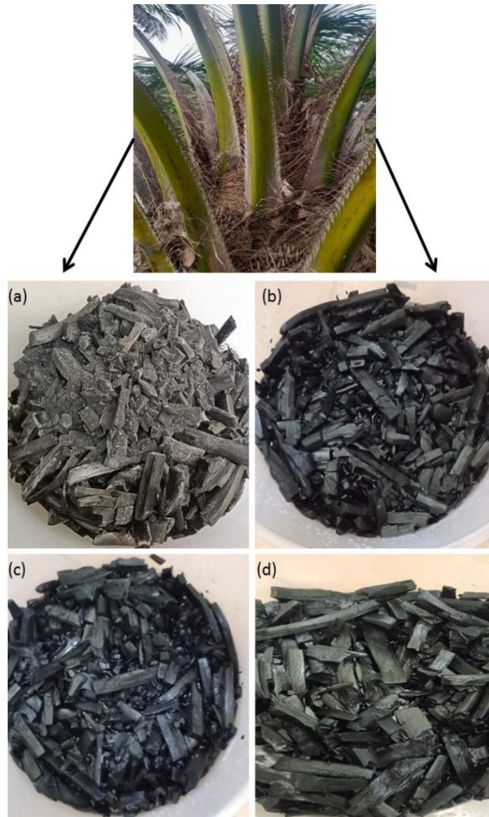
Gambar 1. Konversi limbah biomassa (a) limbah kayu, (b) pelepah sawit tahap 1, (c) bambu, dan (d) pelepah sawit tahap 2 menjadi karbon menggunakan tanur hemat energi.
