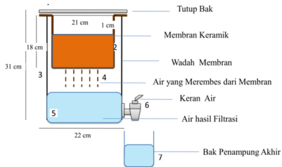
Gambar 1. Desain unit membran keramik.
