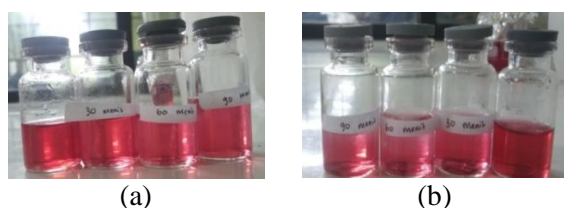
Gambar 5. Hasil filtrat adsorpsi dengan variasi waktu kontak (a) zeolit hijau (b) zeolit coklat.
