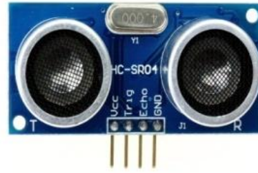
Gambar 2. Modul sensor ultrasonik HCSR-04.
