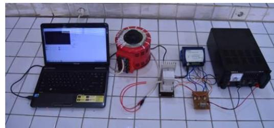
Gambar 6. Susunan alat pengukuran tegangan elemen peltier
