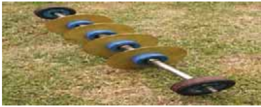
Gambar 5 Bentuk dan dimensi dari elektroda modifikasi Wenner yang dibuat.
